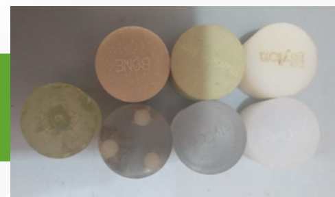
Fabricación de accesorios: Respuesta angular de dosímetros y Materiales para estimación de coeficientes de atenuación.
